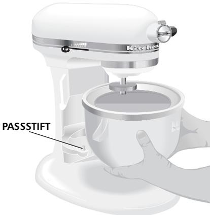
**HINWEIS:** Der Kühlbehälter passt für alle Küchenmaschinen mit anhebbarer Schüssel. Falls der Schüsselstift an der Rückseite des Behälters zu lang oder zu kurz ist, um im Schnappverschluß einzurasten, müssen Sie den Behälter entnehmen und in der anderen Richtung wieder einsetzen, sodass der andere Schüsselstift zum Schnappverschluß weist. Wiederholen Sie dann die Schritte 3 und 4.
