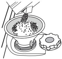
1. Retire la bandeja inferior y desenrosque el tapón del depósito (en sentido antihorario).
