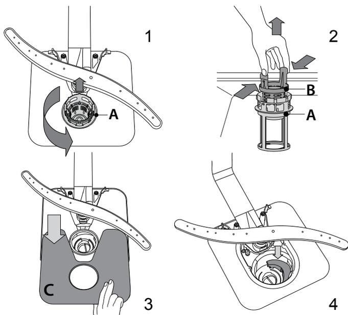
Una vez limpiados los filtros, recolóque el conjunto de filtrado y encájelo correctamente en su sitio; esto es esencial para garantizar el funcionamiento eficiente del lavavajillas.
