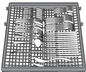
La tercera bandeja está diseñada para alojar los cubiertos. Coloque los cubiertos tal como se muestra en la figura. La colocación por separado de los cubiertos hace que sean más fáciles de recoger después del lavado y mejora el rendimiento del lavado y el secado.
