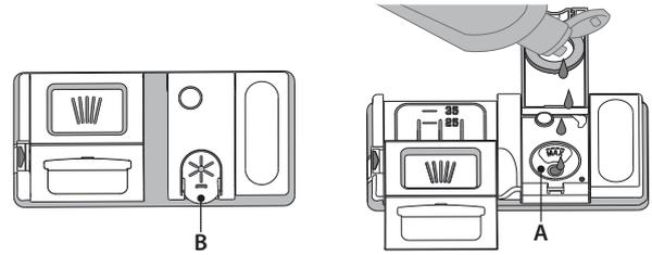
1. Abra el dispensador **B** pulsando y levantando la lengüeta de la tapa.
