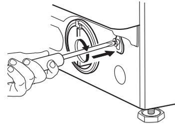
**3.** Drücken Sie das Netzkabel nach unten wie in der folgenden Abbildung angezeigt. An dieser point, Stelle, wird die Tür entriegelt und die Wäsche kann entnommen werden.
