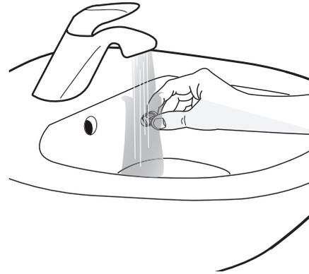
**2.** Das Filtersieb am Ende des Schlauchs mit einer Bürste gründlich reinigen.
