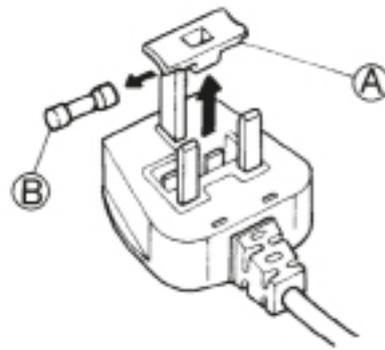
1. Die Sicherungsabdeckung (A) und die Sicherung (B) entfernen.
