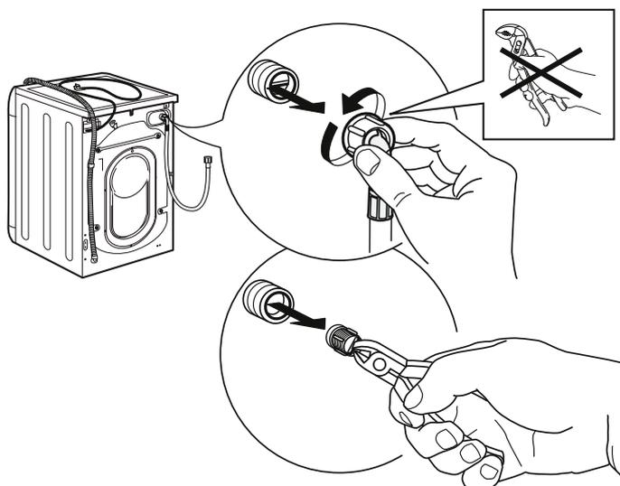
**4.** Das Filtersieb wieder einsetzen. Verbinden Sie den Zulaufschlauch erneut mit dem Wasserhahn und dem Wäschetrockner. Verwenden Sie zum Anschluss des Zulaufschlauchs keine Werkzeuge. Öffnen Sie den Wasserhahn und überprüfen Sie ihn, um sicherzustellen, dass alle Anschlüsse korrekt festgezogen sind.
