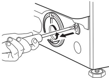
**4.** Befestigen Sie anschließend das Netzkabel erneut, indem Sie die Schraube mit Hilfe eines Schraubenziehers einsetzen.
