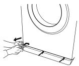
Behälter für das abgelassene Wasser: Platzieren Sie einen niedrigen und breiten Behälter unter dem Wasserfilter, um das Restwasser aufzufangen.
