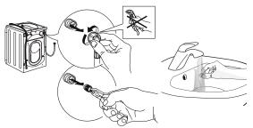
**4.** Filtersieb wieder einsetzen. Schließen Sie den Zulaufschlauch wieder an den Wasserhahn und die Waschmaschine an. Verwenden Sie kein Werkzeug, um den Zulaufschlauch anzuschließen. Öffnen Sie den Wasserhahn und überprüfen Sie, dass alle Anschlüsse dicht sind.
