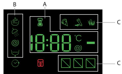
Das Display dient nicht nur zur Programmierung des Gerätes, sondern liefert auch zahlreiche Informationen. Im Abschnitt **A** werden die Dauer der verschiedenen verfügbaren Programme sowie die Restzeit nach Zyklusstart angezeigt; wurde eine STARTZEITVORWAHL eingestellt, dann wird die bis zum Start des ausgewählten Programms verbleibende Zeit angezeigt.
