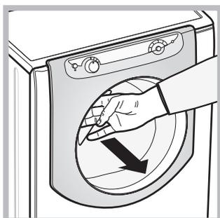
Az ajtó kinyitásához mindig a megfelelő fogantyút használja (lásd ábra).
