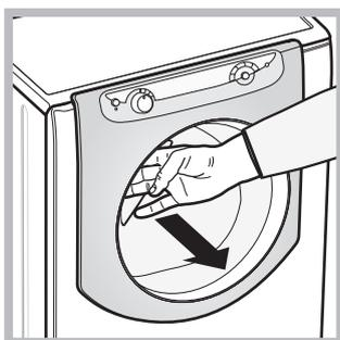
K otevření dvířek s průzorem použijte vždy příslušné madlo (viz obrázek).
