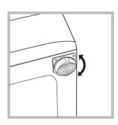
2. Dacă podeaua nu este perfect orizontală, compensați neregularitățile deşurubând sau înşurubând piciorușele anterioare (a se vedea figura); unghiul de înclinare, măsurat pe planul de lucru, nu trebuie să depășească 2°.
