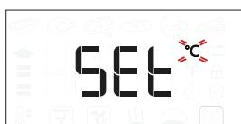
Okrenite gumb za odabir mjerne jedinice i zatim pritisnite za potvrdu.
