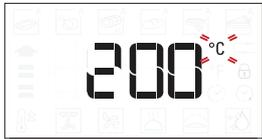
Cuando el icono °C/°F parpadee en la pantalla, gire el selector para cambiar el valor y después pulse
