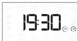
Примечание: Установка отложенного старта отменяет стадию предварительного прогрева духовки. Поскольку духовка выходит на заданную температуру постепенно, время приготовления окажется немного длиннее, чем указано в таблице приготовления.
