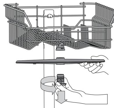
Нижнюю лопасть можно снять, потянув ее вверх.
