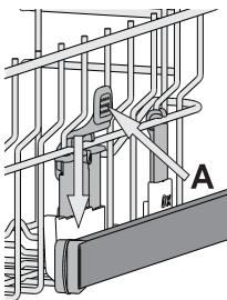
Верхняя корзина снабжена приспособлением для регулировки высоты (см. рисунок). Чтобы поднять
