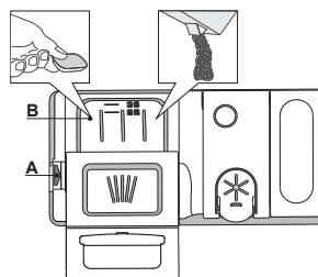
1. Для определения требуемого количества моющего средства см. указания выше. С внутренней стороны лотка В нанесены мерные отметки, позволяющие правильно дозировать моющее средство.
