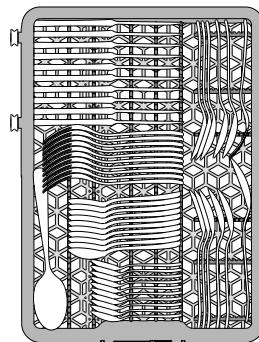
Третья полка посудомоечной машины предназначена для столовых приборов. Размещайте столовые приборы, как показано на рисунке. Раскладывайте столовые приборы по отдельности: это ускорит их последующую сортировку и улучшит качество мойки и сушки.
