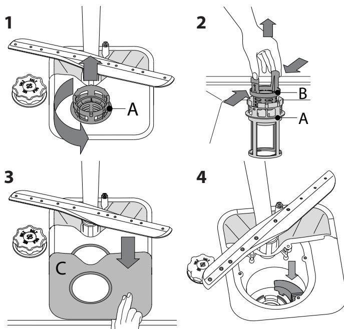
После чистки фильтров установите на место и надежно закрепите фильтрующий узел: это важно для исправной работы посудомоечной машины.
