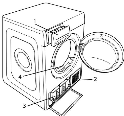
5. Die Rückwand des Bodenfilters wieder schließen und diesen wieder einsetzen, wobei darauf zu achten ist, dass er richtig in seiner Aufnahme sitzt.
