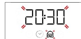
За допомогою кнопки або — встановіть бажаний час завершення готування і натисніть для підтвердження. Активуйте функцію, встановивши ручку *термостата* на бажану температуру: Функцію буде призупинено до її автоматичного запуску після періоду часу, який розраховано так, щоб закінчити приготування у встановлений час.
