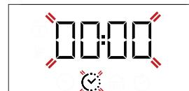
Пісірудің қажет уақытын таңдау үшін + немесе — түймесін пайдаланыңыз және ○ түймесін басыңыз. Функцияны *термостат тетігін* қажетті температуралы бұрау арқылы іске қосыңыз: дыбысты сигнал беріліп, дисплейде пісірудің аяқталғаны көрсетіледі.
