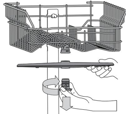
Zur Abnahme des oberen Sprüharms drehen Sie den Kunststoffring im Uhrzeigersinn. Der obere Sprüharm ist mit jener Seite nach oben wieder einzusetzen, die die meisten Löcher aufweist.
