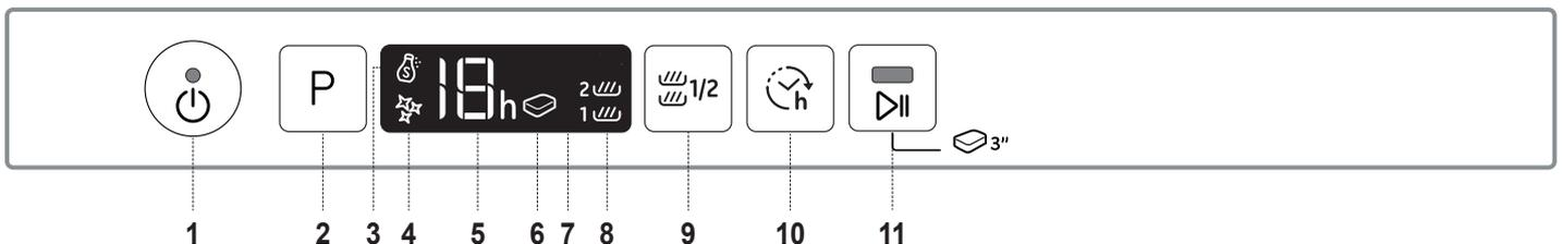
1. Ein-Aus/Reset Taste mit Anzeigelicht
