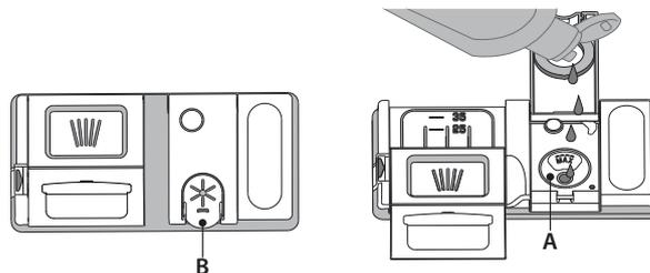
1. Den Behälter **B** durch Drücken und Anheben der Zunge am Deckel öffnen.
