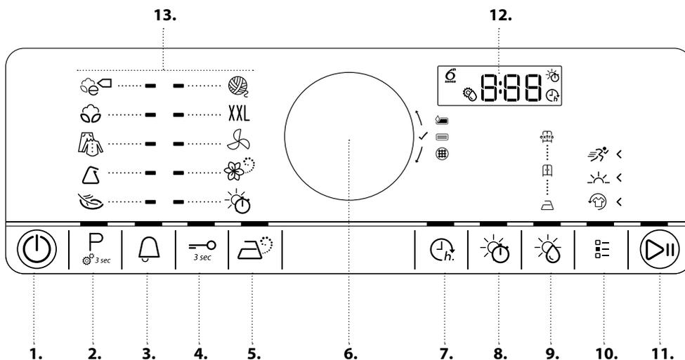
1. An/Aus-Taste (bei langem Tastendruck Rücksetzung)
