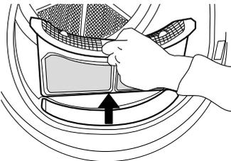
Drücken Sie die Taste, um den Türfilter zu öffnen. Entfernen Sie die Flusen im Inneren. Schließen Sie den Filter und setzen Sie ihn in der richtigen Richtung ein, so dass er vollständig in der Filterkammer integriert ist.
