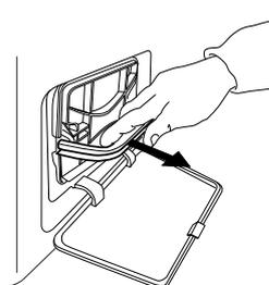
Öffnen Sie die Bodenklappe. Halten Sie den Griff und ziehen Sie den Bodenfilter heraus.
