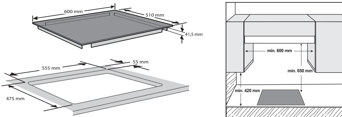
**ПРИМЕЧАНИЕ:** Если расстояние А между настенными шкафчиками составляет от 600 мм до 730 мм, то высота В должна быть не менее 530 мм. Если расстояние "А" между корпусами настенной мебели больше ширины варочной панели, то высота "В" должна быть не менее 400 мм. В случае установки над варочной панелью вытяжки необходимо соблюдать размеры, указанные в руководстве по эксплуатации вытяжки
