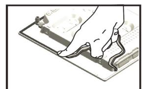
Для крепления варочной панели используйте скобы (A), входящие в комплект поставки. Вставьте скобы в соответствующие отверстия (они обозначены стрелкой) и закрепите их винтами в соответствии с толщиной столешницы (см. рисунки ниже).
