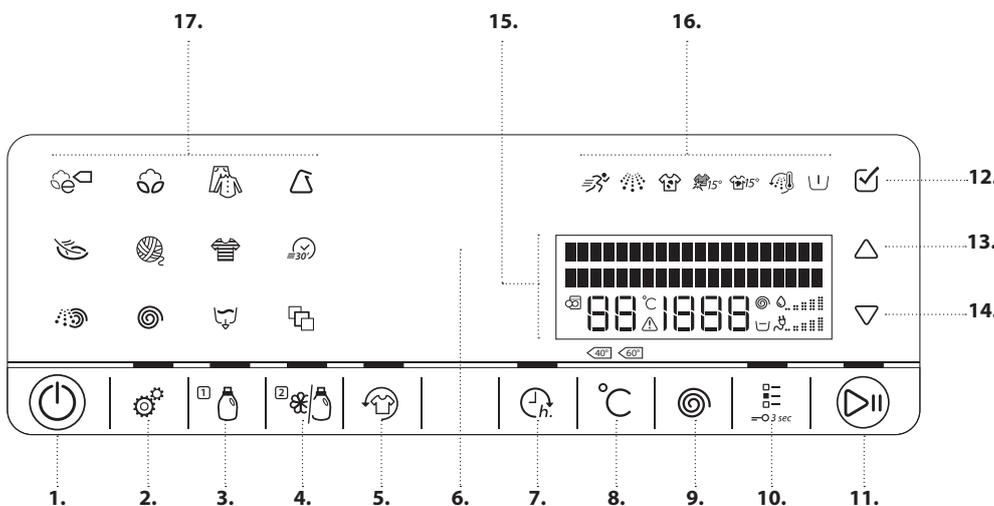
1. Ein/Aus-Taste (bei gehaltenem Tastendruck Rücksetzung/Abpumpen)
