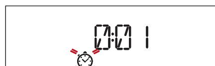
Tournez le *bouton de réglage* pour régler la durée requise et appuyez sur la *touche de sélection/confirmation* de nouveau pour activer la minuterie. Un signal sonore se fait entendre et une indication apparaît à l'écran lorsque la minuterie a terminé le compte à rebours.
