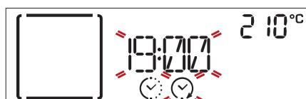
Вращая ручку регулировки, установите желаемое время окончания приготовления и нажмите кнопку выбора/подтверждения, чтобы подтвердить значение и ввести в действие выбранный режим. Поместите продукт в духовку и закройте дверцу: Процесс приготовления стартует автоматически в нужный момент, рассчитанный так, чтобы блюдо оказалось готово к установленному вами времени.
