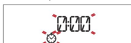
Примечание: Таймер не запускает какие-либо режимы приготовления. Для изменения заданного времени таймера используйте **ручку регулировки**. Поверните ручку выбора на 0, чтобы выключить таймер в любой момент времени.
