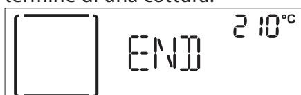
Premere il *tasto di selezione/conferma* per continuare la cottura in modalità manuale (senza una durata impostata) o ruotare la *manopola di regolazione* per prolungare la cottura impostando una nuova durata.
