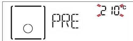
Cuando el precalentamiento haya terminado, sonará una señal acústica y la pantalla indicará que el horno ha alcanzado la temperatura establecida. En este momento, abra la puerta, coloque los alimentos en el horno y cierre para iniciar la cocción.
