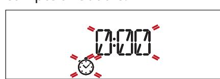
Veuillez noter : Le minuteur ne démarre pas de cycle de cuisson. Utilisez le *bouton de réglage* pour changer le temps réglé sur la minuterie; tournez le *bouton de réglage* sur 0 pour éteindre la minuterie en tout temps.
