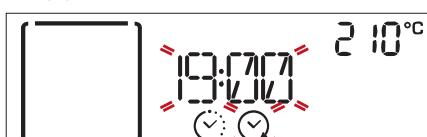
Draai aan de *instelknop* om de gewenste eindtijd van de bereiding in te stellen en druk dan op de *selectie-/bevestigingstoets* om te bevestigen en de functie te starten.
