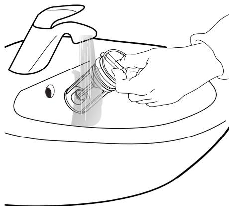
**6.** Inserte el filtro de agua y vuelva a instalar el zócalo: Vuelva a insertar el filtro de agua girándolo en el sentido de las agujas del reloj. Asegúrese de que lo ha girado todo lo posible el agarre del filtro debe estar en posición vertical. Para probar la estanqueidad del filtro de agua, puede verter alrededor de un litro de agua en el dispensador de detergente. Y reinstalar el zócalo a continuación.
