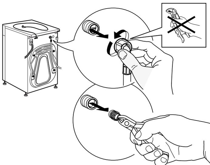
**4.** Vuelva a introducir el filtro de malla. Vuelva a conectar la manguera de entrada al grifo y a la máquina. No utilice ninguna herramienta para conectar la manguera de entrada. Abra el grifo y compruebe que las conexiones estén bien ajustadas.
