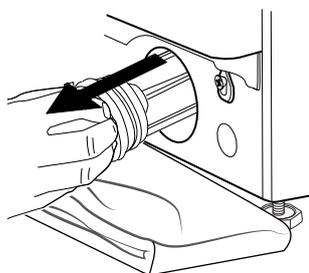
**5.** Limpie el filtro de agua: retire los residuos del filtro y lávelo con agua corriente.
