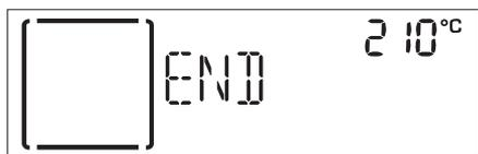
Premere **OK select** per continuare la cottura in modalità manuale (senza una durata impostata) o ruotare la *manopola di regolazione* per prolungare la cottura impostando una nuova durata.
