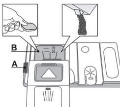
**Per aprire il distributore detersivo utilizzare il dispositivo di apertura A.**
