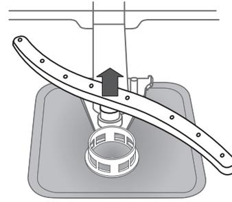
Нижнюю лопасть можно снять, потянув ее вверх.
