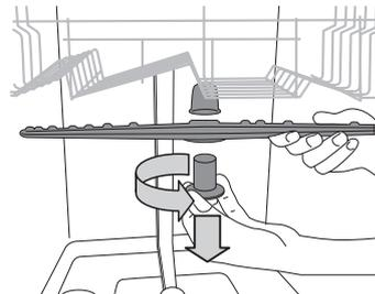
Для снятия верхней лопасти поверните пластмассовое удерживающее кольцо против часовой стрелки. Устанавливайте верхнюю лопасть так, чтобы сторона с большим количеством отверстий была обращена вверх..
