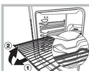
**ВНИМАНИЕ!** Духовой шкаф укомплектован системой блокировки решеток, позволяющей вынимать их из духовки не полностью (1). Для полного вынимания решеток достаточно поднять их, как
