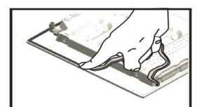
Для крепления варочной панели используйте скобы (A), входящие в комплект поставки. Вставьте скобы в соответствующие отверстия (они обозначены стрелкой) и закрепите их винтами в соответствии с толщиной столешницы (см. рисунки ниже).
