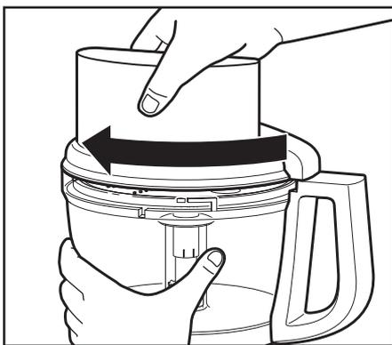
4. Si hay un disco instalado, retírelo antes de sacar el bol. Sujete el disco por los dos puntos de agarre y levántelo verticalmente. Retire el adaptador.
