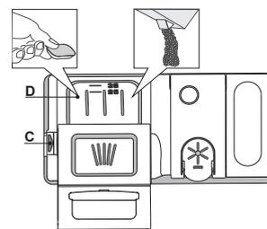
**Para abrir o distribuidor de detergente, utilize o dispositivo de abertura C. Coloque o detergente apenas no distribuidor seco D. Coloque a quantidade de detergente para pré-lavagem diretamente na cuba.**
