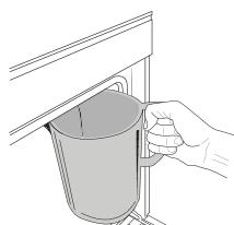
Po izboru funkcije „Odvod vode“ ili kada je to prikazano na displeju, pritisnite
