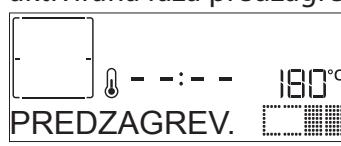
Kada se ova faza završi, oglasiće se zvučni signal i na displeju se prikazuje da je rerna dospila podešenu temperaturu, tražeći „DODAJTE HRANU“.
