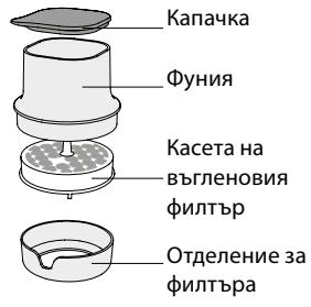
Фиг. 1 Резервоар за вода
