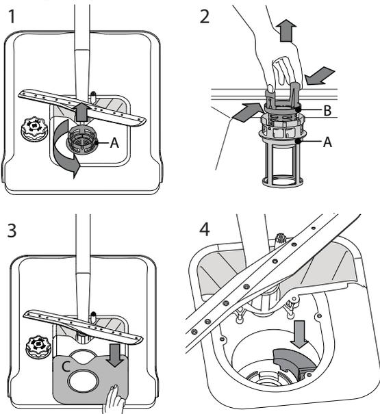
Una vez limpiados los filtros, recolóque el conjunto de filtrado y encájelo correctamente en su sitio; esto es esencial para garantizar el funcionamiento eficiente del lavavajillas.
