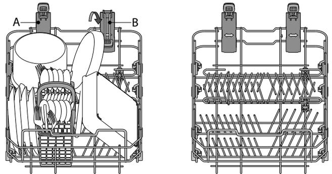
La bandeja inferior tiene unos soportes desplegables que se pueden utilizar en posición vertical cuando se coloquen platos o en posición horizontal (más baja) para cargar cacerolas y ensaladeras fácilmente.
