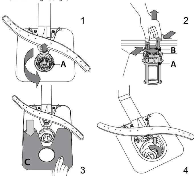
Una vez limpiados los filtros, recolocarlo el conjunto de filtrado y encájelo correctamente en su sitio; esto es esencial para garantizar el funcionamiento eficiente del lavavajillas.
