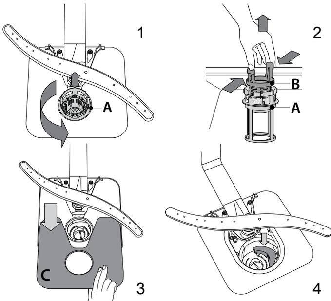
Una vez limpiados los filtros, recolocque el conjunto de filtrado y encájelo correctamente en su sitio; esto es esencial para garantizar el funcionamiento eficiente del lavavajillas.
