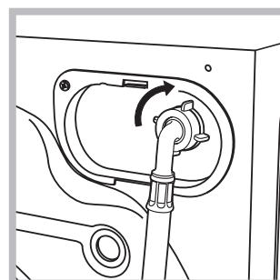
2. Pripojte prítokovú hadicu k práčke, jej zaskrutkováním k príslušnej prípojke na vodu, umiestnenej vpravo hore (viď obrázok).
