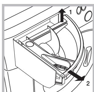
Vytáhněte dávkovač jeho nadzvednutím a vytažením směrem ven (viz obrázek). Umyjte jej pod proudem vody; tento druh vyčištění je třeba provádět pravidelně.
