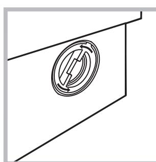
2. Odšroubujte víko jeho otáčením proti směru hodinových ručiček (viz obrázek): vytěčení malého množství vody je zcela běžným jevem;
