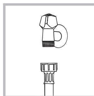
1. Pripojte prívodnú hadicu jej zaskrutkováním ku kohútiku so studenou vodou, s hrdlom so závitom 3/4" (viď obrázok). Pred pripojením hadice nechajte vodu odtieť, až kým nebude číra.
