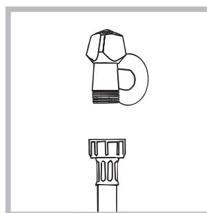
1. Підключіти трубу подачі, прикрутивши її до крану холодної води за допомогою штуцера з газовою різьбою 3/4 (див. схему). Перед підключенням зливайте воду, доки вона не стане прозорою.
