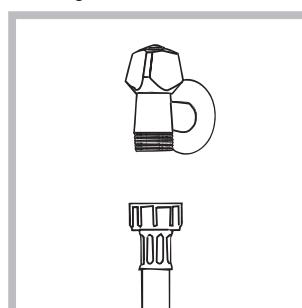
1. Podłącz przewód zasilający poprzez przykrecenie go do zaworu zimnej wody z końcówką gwintowaną (patrz rysunek): Przed podłączeniem spuszczać wodę do momentu, aż stanie się ona całkowicie przezroczysta.
