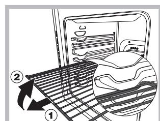
**ATTENZIONE** Il forno è dotato di un sistema di arresto griglie che consente di estrarre senza che queste fuoriescano dal forno. (1)
