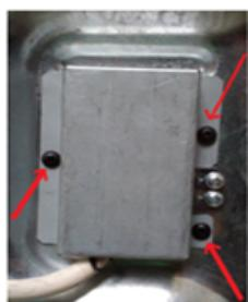
Dopo avere installato il cavo di alimentazione, fissare il coperchio metallico con tre viti.
