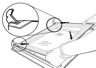
**4. Replacez le bord supérieur : un déclic indique le positionnement correct. Assurez-vous que le joint est bien placé avant de replacer la porte.**
