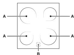
B. Wärmeanzeige: zeigt an, dass die Temperatur der entsprechenden Kochzone über 60°C liegt, auch wenn das Element ausgeschaltet aber noch warm ist.
