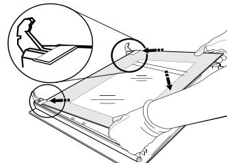
**4. Rimontare il profilo superiore:** un clic indica il corretto posizionamento. Verificare che la tenuta sia salda prima di rimontare la porta.
