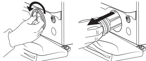
5. Očistite filter za vodu: uklonite ostatke u filtru i očistite ga tekućom vodom.
