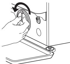
4. Uklonite filter: Stavite pamučnu krpu ispod filtra za vodu koja može upiti malu količinu preostale vode. Zatim uklonite filter za vodu tako da ga okrenete u smjeru suprotno od smjera kazaljke na satu.
