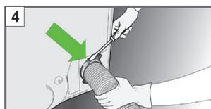
Fixez le tuyau de ventilation à la sortie d'aération arrière en serrant le collier de serrage avec un tournevis. Si le tuyau n'a pas été étendu, le collier ne fixera pas le tuyau à la sortie d'aération arrière.
