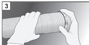
Placez un collier de serrage sur la fin du tuyau d'aération étendu. Un collier de serrage supplémentaire peut être utilisé pour fixer l'extrémité opposée du tuyau d'aération à un kit de montage mural (kit et collier non fournis).
