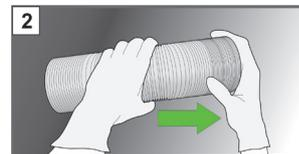
Tirez pour étendre la fin du tuyau de ventilation avant le raccord. Si le tuyau n'a pas été étendu, le collier de serrage ne fixera pas le tuyau à l'adaptateur.
