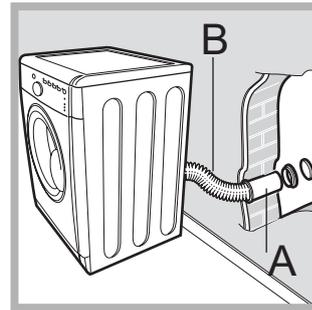
Le trou doit être aussi bas que possible et le tube doit être maintenu le plus court possible. En fonction de la fréquence d'utilisateur de votre sèche-linge, il est essentiel de vérifier régulièrement les zones A et B pour enlever les peluches et les débris. Assurez-vous que le tuyau de ventilation, les ventilateurs d'entrée d'air et les sorties ne sont pas obstrués ou bloqués.
