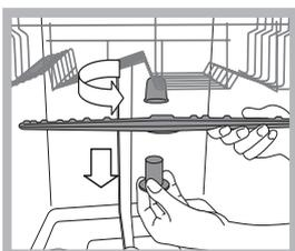
Per smontare l'irroratore superiore, occorre svitare girando in senso antiorario la ghiera di plastica. L'irroratore superiore, va rimontato con la parte con il maggior numero di fori rivolta verso l'alto.
