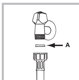
1. Підключити живлячу трубопровід, прикрутивши його до крану холодної води за допомогою штуцера з газовою різьбою 3/4 (див. малюнок). Перед підключенням спустіть воду, доки вона не стане прозорою.
