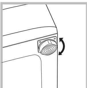
2. Якщо підлога не є ідеально горизонтальною, компенсуйте нерівності за допомогою передніх ніжок (див. малюнок) – розкручуючи чи закручуючи їх; кут нахилу відносно робочої поверхні не повинен перевищувати 2°.
