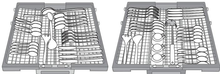
As facas e os outros utensílios afiados têm de ser colocados com as lâminas voltadas para baixo.
