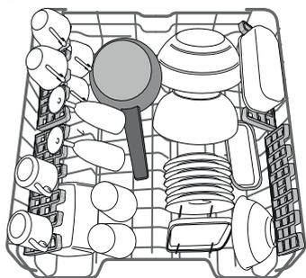
O cesto superior tem suportes rebatíveis, que podem ser utilizados numa posição vertical para colocar pires de chá/sobremesa ou numa posição inferior, para colocar tigelas e recipientes.
