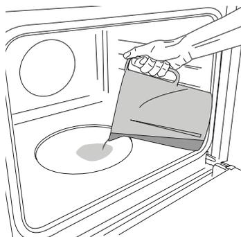
Quando o forno estiver frio, encha a reentrância com a quantidade de água potável sugerida na tabela de cozedura relevante. Coloque os alimentos no forno.
