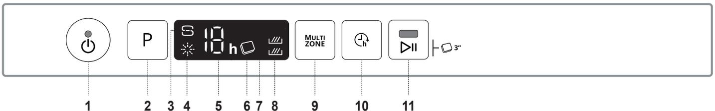
1. Ein-Aus/Reset Taste mit Anzeigelicht
