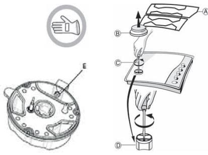
Прежде чем устанавливать варочную панель, не забудьте прикрепить прилагаемую к инжекторам табличку с данными, касающимися нового типа газа, таким образом, чтобы она закрыла собой табличку, относящуюся к предыдущему типу газа
