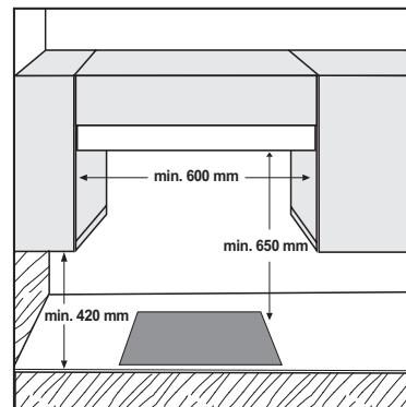
**ПРИМЕЧАНИЕ:** Если расстояние А между настенными шкафчиками составляет от 600 мм до 730 мм, то высота В должна быть не менее 530 мм. Если расстояние "А" между корпусами настенной мебели больше ширины варочной панели, то высота "В" должна быть не менее 400 мм. В случае установки над варочной панелью вытяжки необходимо соблюдать размеры, указанные в руководстве по эксплуатации вытяжки
