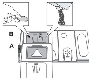
**Zum Öffnen des Spülmittelbehälters den Öffnungsmechanismus A drücken. Füllen Sie das Spülmittel ausschließlich in das trockene Fach B ein. Die für den Vorspülgang benötigte Spülmittelmenge wird direkt in den Geschirrspüler gegeben.**
