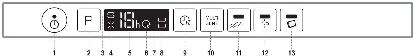
1. Ein-Aus/Reset Taste mit Anzeigelicht
