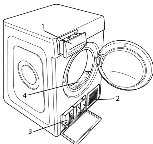
**Os filtros são componentes fundamentais para a secagem da roupa. Servem para reter fiapos e algodão que se formam durante a secagem. No caso de um dos filtros ficar obstruído, o fluxo de ar no interior da máquina de secar ficaria gravemente comprometido: os tempos de secagem seriam maiores, como também o consumo de energia aumentaria, e a máquina de secar poderia ficar danificada. Se estas operações não forem efetuadas corretamente, a máquina de secar pode deixar de funcionar.**
