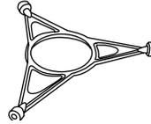
Utilisez le support uniquement pour la plaque tournante en verre. Ne placez pas d'autres accessoires sur le support.
