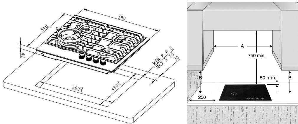
Примечание: Если расстояние "A" между навесными шкафами составляет от 600мм до 730мм, то высота "B" должна быть как минимум 530мм.
