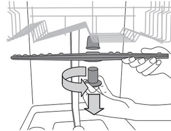
Per smontare il braccio aspersore superiore, ruotare l'anello di bloccaggio in plastica in senso antiorario. Il rimontaggio del braccio aspersore deve avvenire in modo che il lato con il maggior numero di fori sia rivolto verso l'alto.
