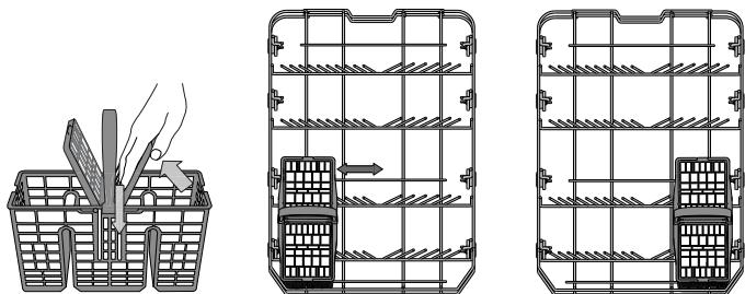
**Ножи и другие острые предметы следует укладывать в корзинку для столовых приборов острыми краями вниз либо кладь горизонтально на откидные секции верхней корзины.**
