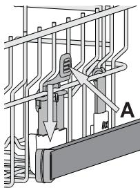
Верхняя корзина снабжена приспособлением для регулировки высоты (см. рисунок). Чтобы поднять верхнюю корзину, просто потяните ее вверх за края, не нажимая рычаги, пока она не займет устойчивое положение вверху.
