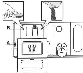
1. Для определения требуемого количества моющего средства см. указания выше. С внутренней стороны лотка **B** нанесены мерные отметки, позволяющие правильно дозировать моющее средство.
