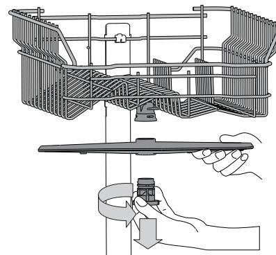
Нижнюю лопасть можно снять, потянув ее вверх.
