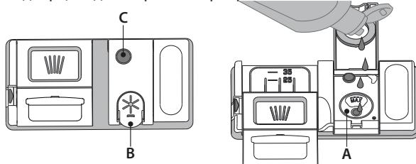
1. Откройте дозатор **B**, нажав и потянув вверх язычок крышки.
