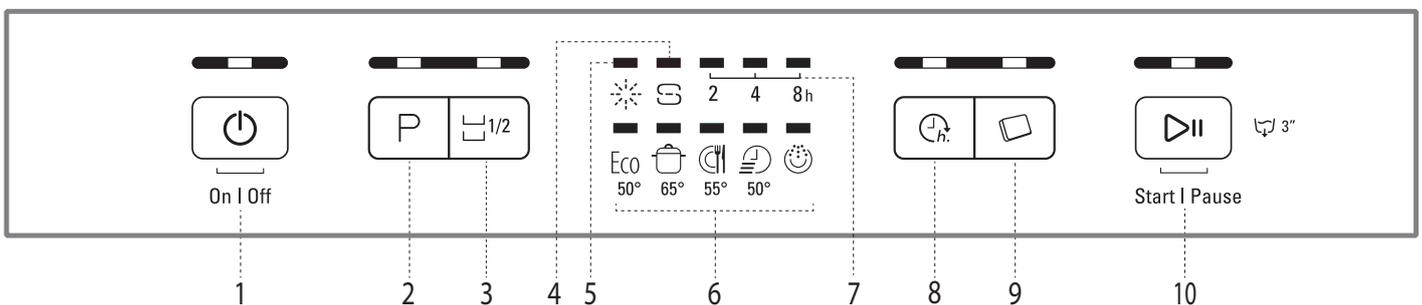
1. Ein-Aus/Reset Taste mit Anzeigelicht
