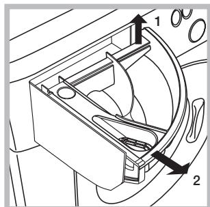
Выньте распределитель, приподняв его и потянув наружу (см. схему). Промойте распределитель теплой водой. Эта операция должна выполняться регулярно.
