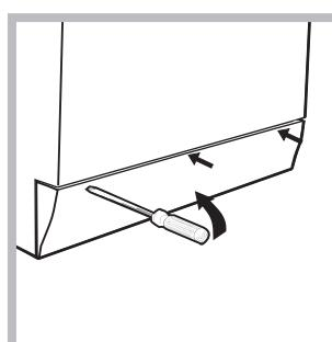
1. rimuovere il pannello di copertura sul lato anteriore della macchina con l'aiuto di un giravite (vedi figura);
