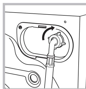
2. Підключіть трубу подачі води до пральної машини, під'єднавши його до водорозбірного крану, який знаходитьться угорі праворучназадньому боці машини (див. малюнок).
