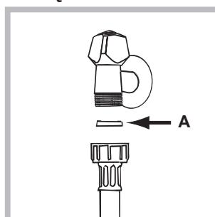
1. Wsunąć uszczelkę A do końca rury pobierania wody i przykroić ją do kurka zimnej wody o gwintowanym otworze 3/4" (zobacz rysunek). Przed podłączeniem spuszczać wodę do momentu, aż stanie się ona całkowicie przezroczysta.
