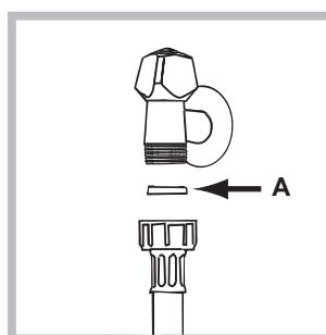
1. Inserire la guarnizione A nell'estremità del tubo di alimentazione e avitarlo a un rubinetto d'acqua fredda con bocca filettata da 3/4 gas (vedi figura). Prima di allacciare, far scorrere l'acqua finché non sia limpida.
