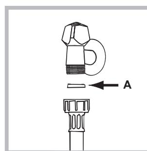
1. Вставьте прокладку A в конец заливного шланга и наверните его на вывод водопровода холодной воды с резьбовым отверстием 3/4 дюйма (см. рис.).
