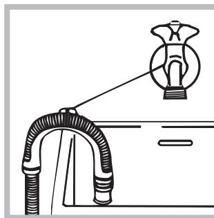
sau sprijiniți pe marginea unei chiuvete sau a unei căzi, legând elementul de ghidare la robinet (a se vedea figura). Capătul liber al furtunului de golire nu trebuie să rămână cufundat în apă.
