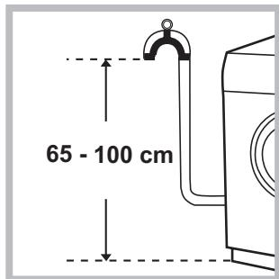
Conectați furtunul de evacuare, fără al îndoi, la o conductă sau la o gură de evacuare în zid, situată între 65 și 100 cm de pământ;
