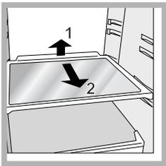
Jsou vyjímatelné a výškově nastavitelné prostřednictvím příslušných vodicích drážek (viz *obrázek*), sloužících k zasunutí prostorných nádob nebo potravin. Nastavení výšky nevyžaduje úplné vytažení police.
