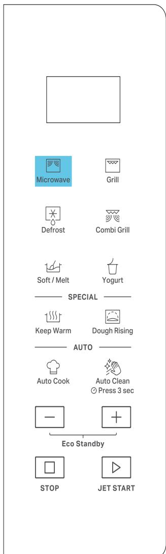
FOR KUN AT TILBEREDE MED MIKROBØLGE, skal du trykke gentagne gange på knappen Microwave (Mikro), for at vælge styrken. Brug derefter +/- knapperne til at indstille den ønskede tilberedningstid. Den længste tilberedningstid er 90 minutter.
