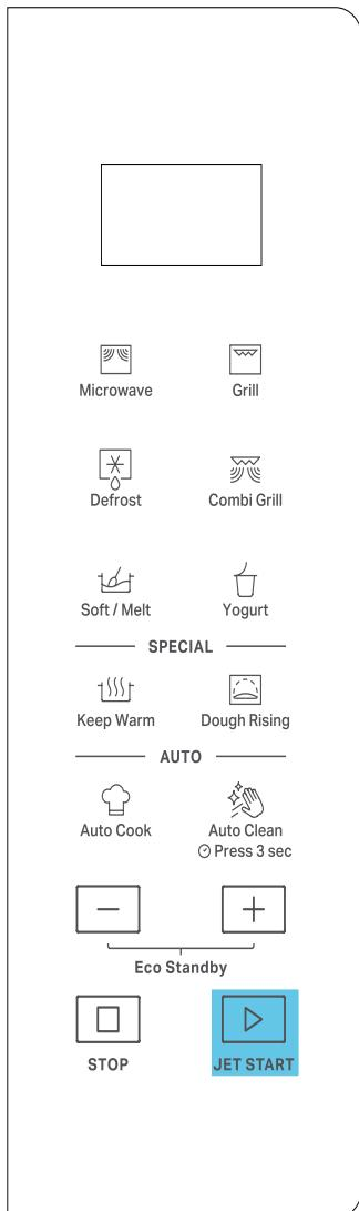
**MED DENNE FUNKTION** kan du hurtigt starte ovnen. Tryk på JET START-knappen, hvorefter ovnen begynder at køre på fuld styrke. Tryk på JET START-knappen igen under tilberedelsen, for at tilføje mere tid. Den længste tilberedningstid er 90 minutter.
